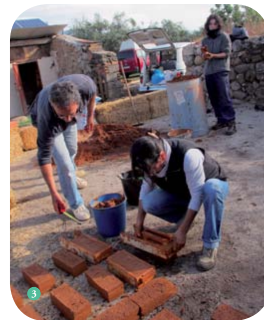
Arriba: Las adoberas son los moldes que utilizaremos para dar forma a los adobes. Abajo: El proceso de fabricación de los adobes es bastante mecánico y muy sencillo.
