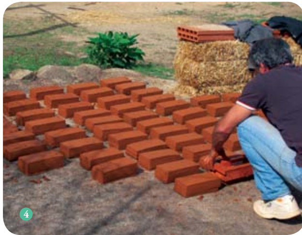
Arriba: En unas horas habremos conseguido el centenar de adobes necesarios para la fabricación de nuestro horno de barro. Abajo: Secado al aire libre.
